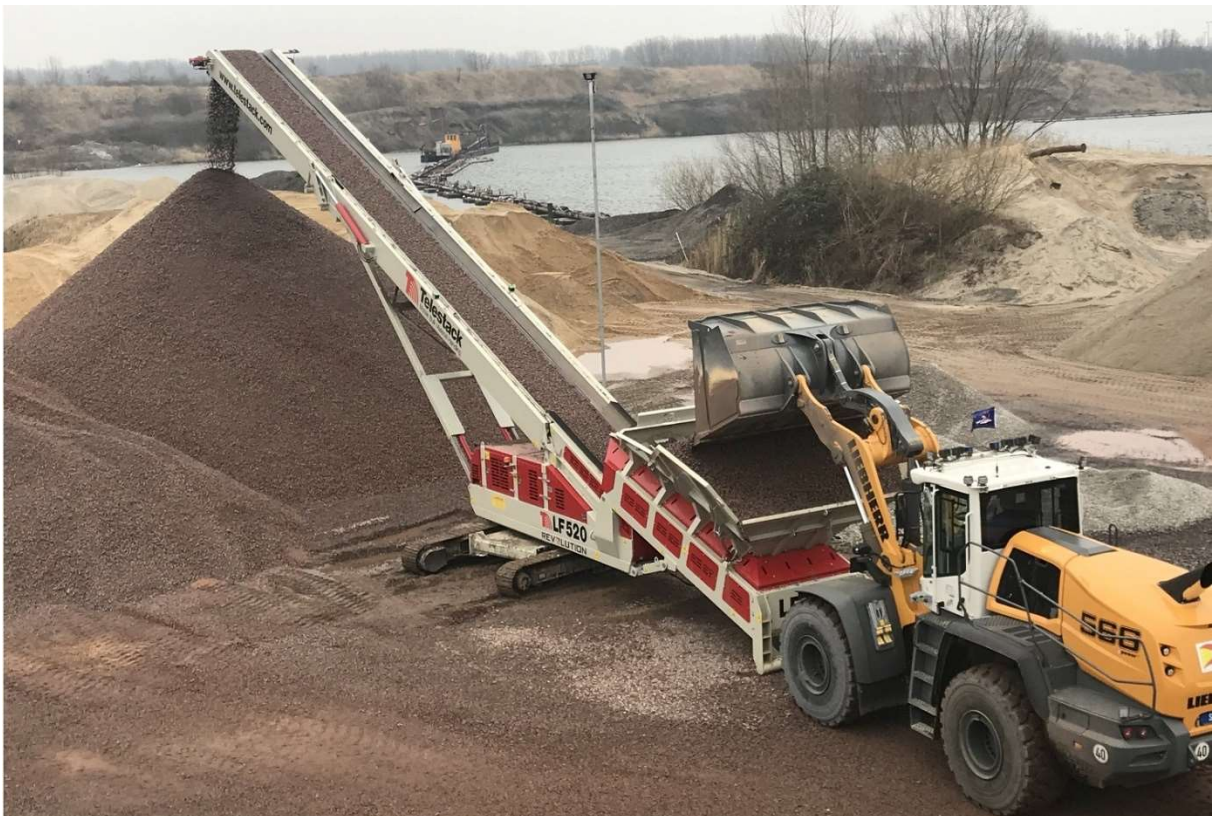
MYND 2.4 Dæmi um hjólaskóflu og sambærilegt hreyfanlegt matarafæriband eins og til stendur að nota. Á Mýrdalssandi verður færribandið þó lokað. Mynd: Telestack.
