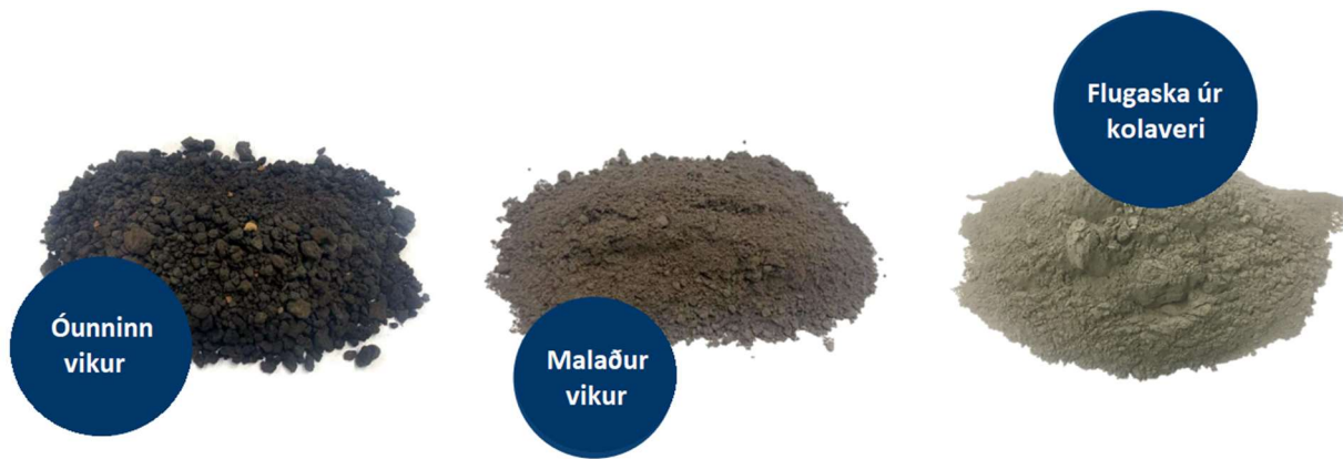
MYND 2.1 Vikurinn er sambærilegur flugösku í bæði gæðum og lit og uppfyllir allar kröfur evrópustaðalsins ÍST EN 197-1.
