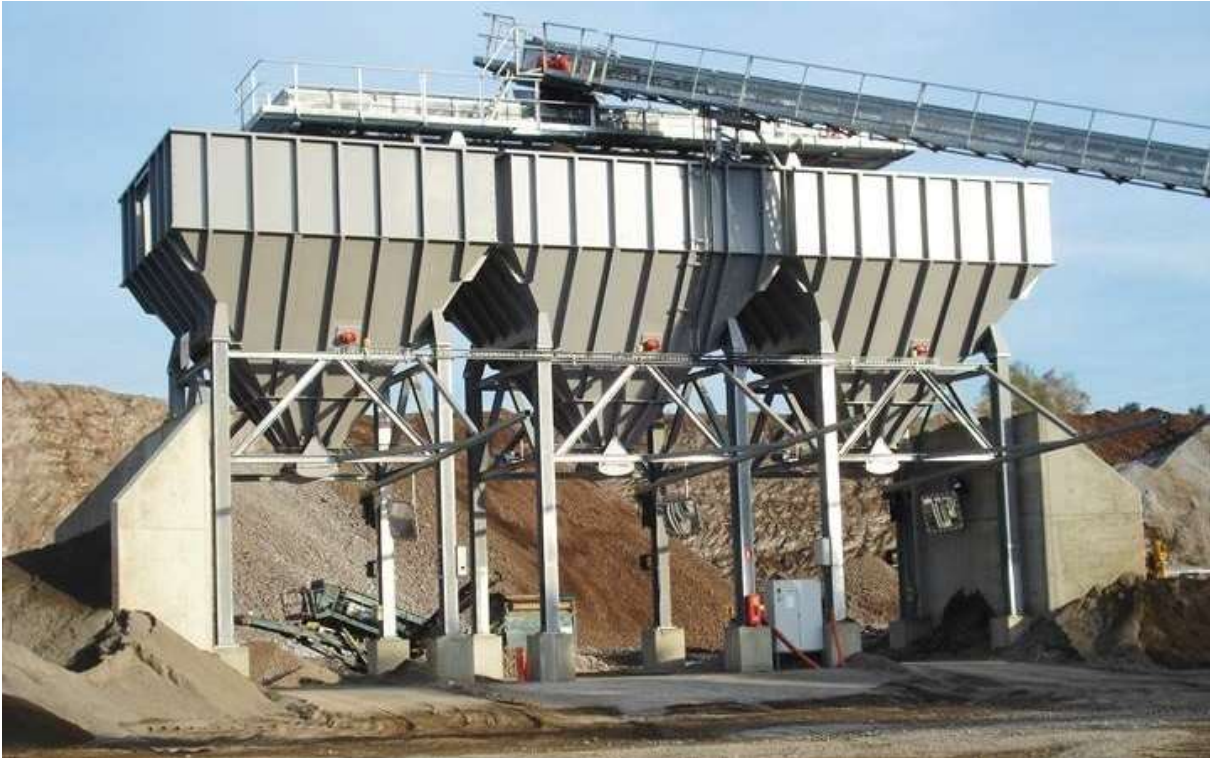
MYND 2.7 Dæmi um hleðslustöð. Stöðin á myndinni getur hlaðið þrjá bíla en gert er ráð fyrir að á Mýrdalssandi verði hægt að hlaða tvo bíla samtímis.
