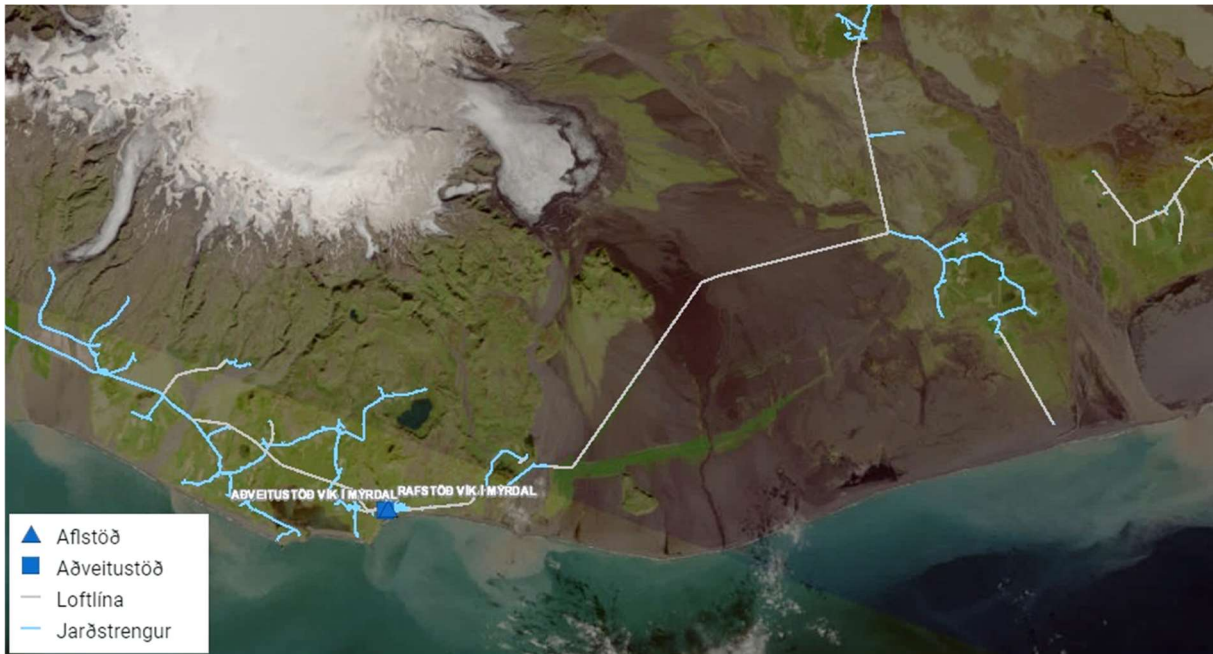
MYND 2.8 Dreifikerfi RARIK á Mýrdalssandi liggur þvert í gegnum efnistökusvæðið. Mýrdalsjökull er uppi til vinstri og efnistökusvæðið er dökki sandurinn fyrir miðri mynd. Ljósleiðari liggur sömu leið. Mynd: Kortasjá á www.rarik.is
